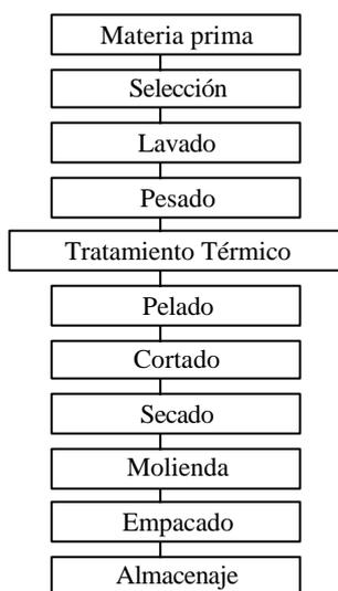
**Figura 2.1** Diagrama de flujo para la obtención de harina de pijuayo
