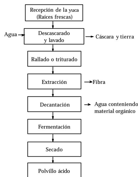
**Figura 2:** Proceso de fabricación del polvillo ácido
