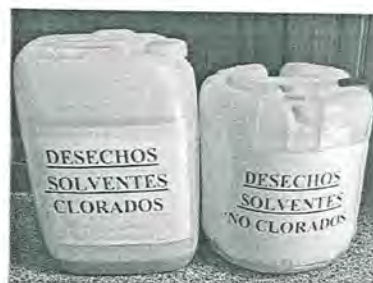
Almacenamiento de residuos peligrosos líquidos.
