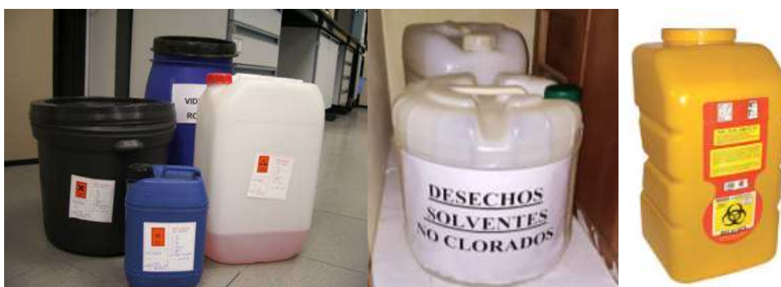
Fotografía 16: Dispositivos para almacenar residuos peligrosos líquidos
